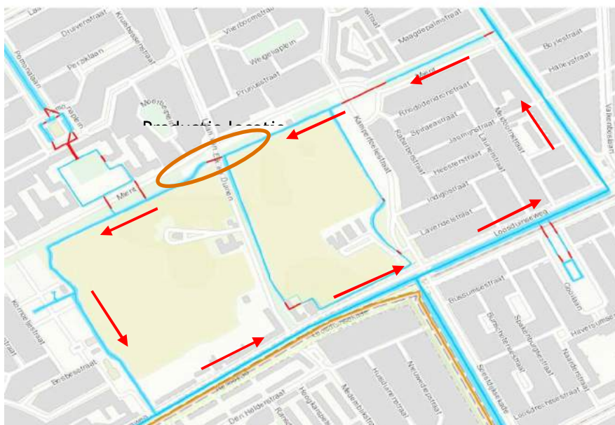
Figuur 4.3 | Potentiële productie locatie TEQ: de duiker bij de productie locatie kan ingezet worden als persleiding voor circulatie van oppervlaktewater in het Mient-Circuit. Het oppervlaktewater bij het onttrekkingspunt zal op die manier niet worden beïnvloed door terugstromend lozingswater.
